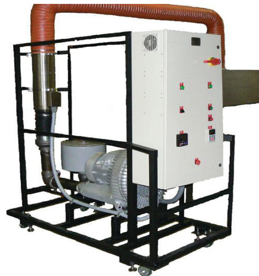
Bild 2. Bedienpult und Lüfter auf einem beweglichen Rollenwagen mit akustisch verstärktem Trocknerbereich rechts im Hintergrund
